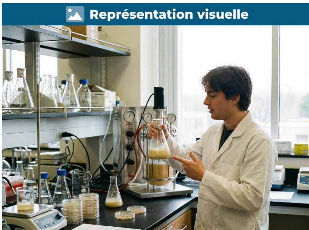
Fermentation par levures, conversion de glucose en éthanol en 48 heures à 30°C
